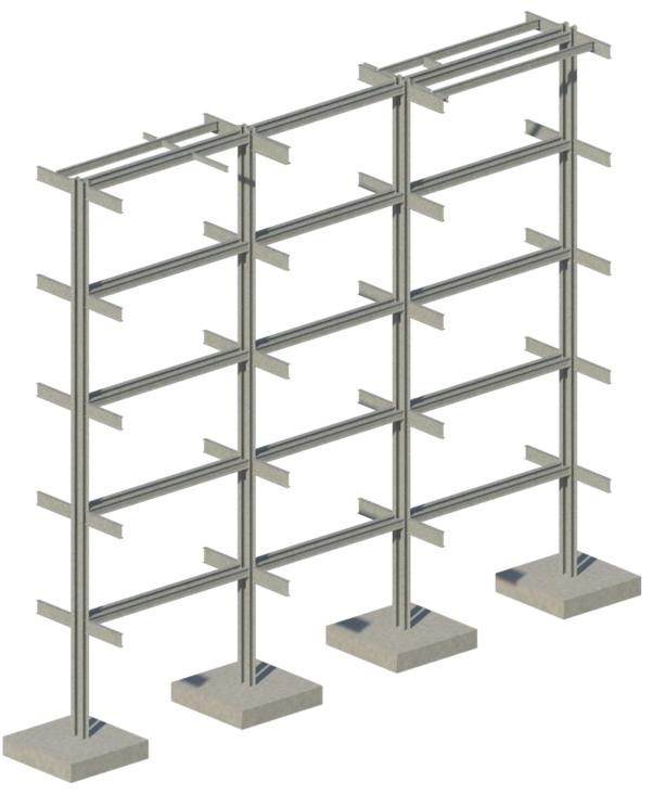
FIGURE 37: EXPANSION JOINT STRUCTURAL FRAME SYSTEM
